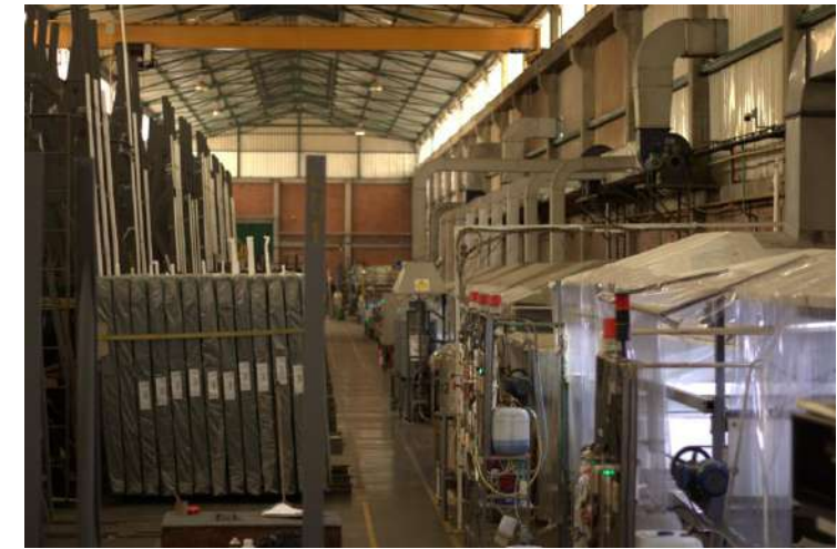
Nuestra línea de producción hoy con capacidad de aprox. 45 ton en 1 solo turno y con capacidad de producir espesores de 2 – 6mm
