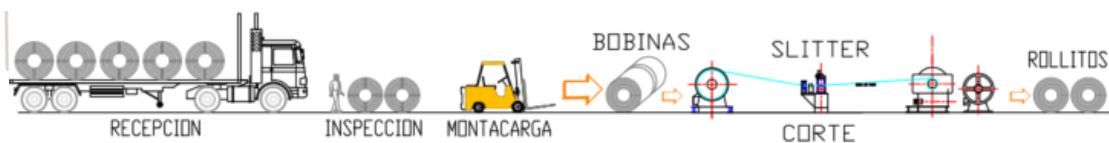
Gráfico 4. Diagrama proceso productivo tubería IMC Y RMC
