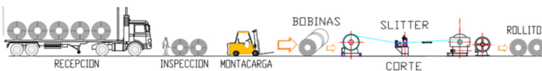
Gráfico 4. Diagrama proceso productivo tubería IMC Y RMC
