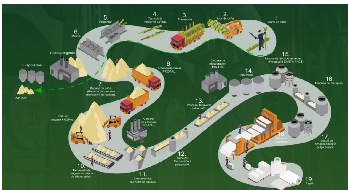
Imagen 1. Diagrama del proceso productivo de papel a partir de caña de azúcar
