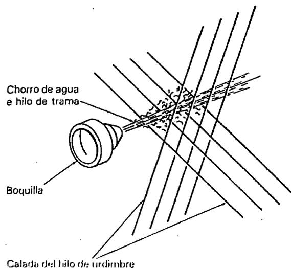
**Figura 4.** Los chorros de agua transportan el hilo de trama a través de la calada de urdimbre. Fuente: Hollen (1999).
