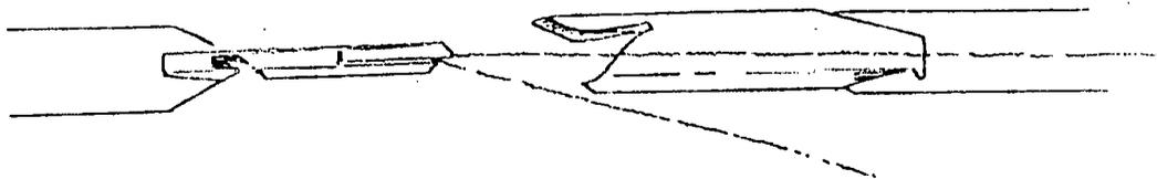
**Figura 5. Brazos de un telar sin lanzadera tipo espadín. Fuente: Hollen (1999).**
